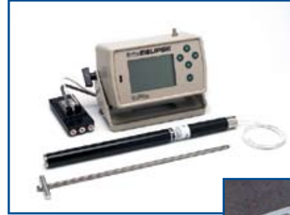
Eclipse® रिसेवर (दाये) तथा केबिल सिस्टम (ऊपर), दर्शाते हुये, ऊपर से, पॉवर स्रोत के साथ केबिल उदयत रिमोट डिसप्ले, केबिल ट्रांसमीटर तथा बाहर निकालने/ अन्दर रखने का टूल
