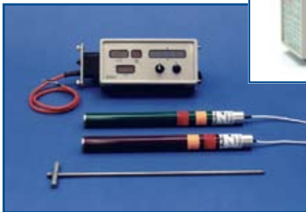
मार्क III रिमोट रिसेवर (ऊपर) तथा केबिल सिस्टम (दाये), दर्शाते हुये, ऊपर से, पॉवर स्रोत के साथ केबिल उदयत रिमोट डिसप्ले, स्टैण्डर्ड तथा संवेदनशील पिच केबिल ट्रांसमीटर तथा बाहर निकालने/ अन्दर रखने का टूल
