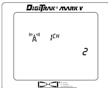
Установка телеметрического канала
