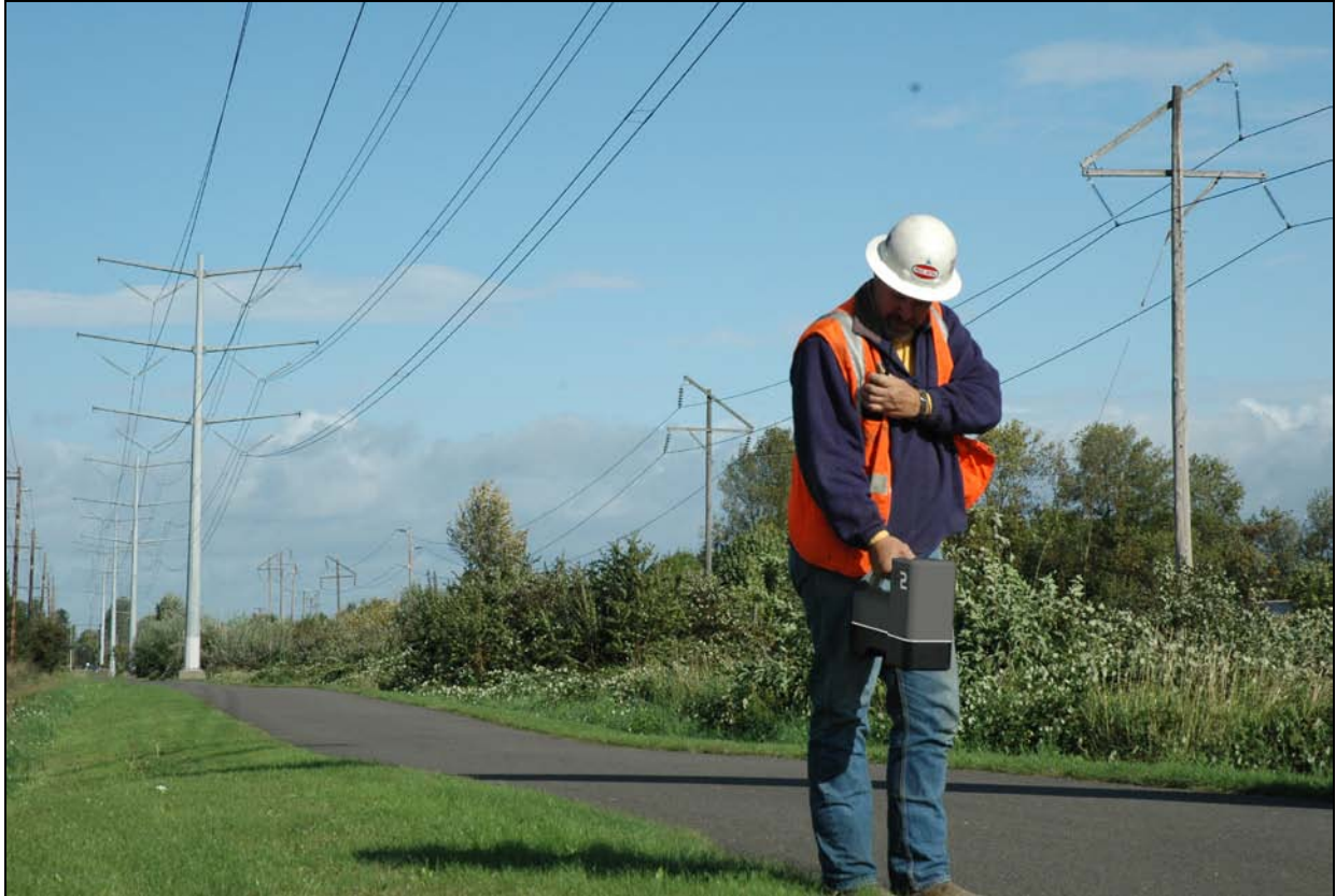
使用 F2 接收器在高干扰地区进行定位操作
