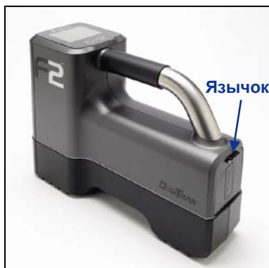
Правильно установленный аккумулятор
