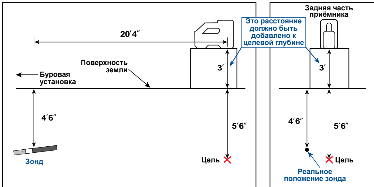
Вид зонда, цели и поднятого приёмника сбоку и с торца
