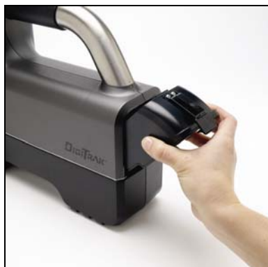
Inserção do pacote de baterias
