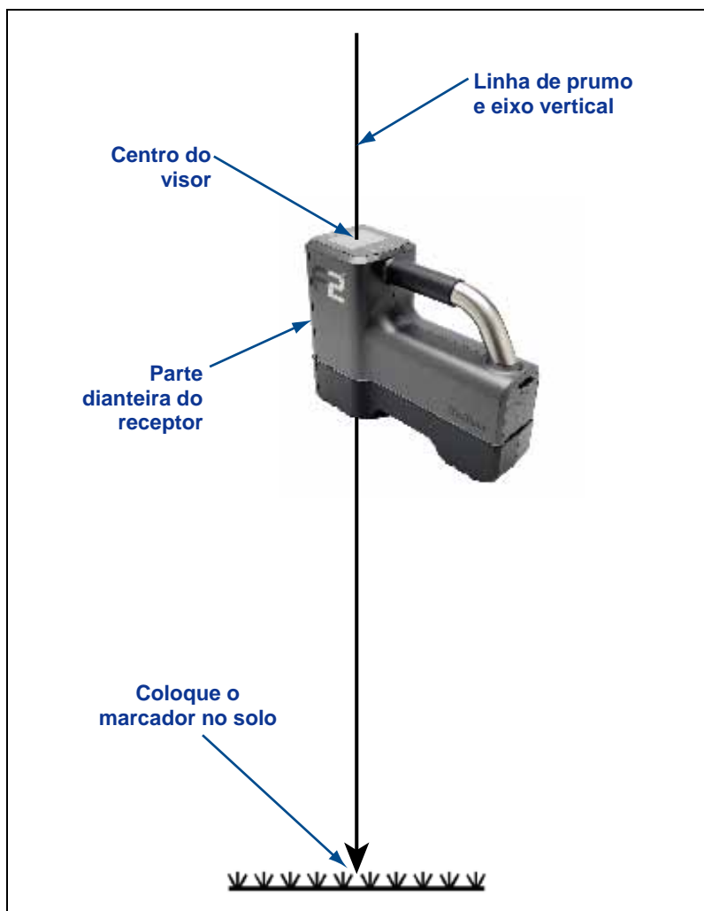
Linha de prumo para marcar pontos de localização
