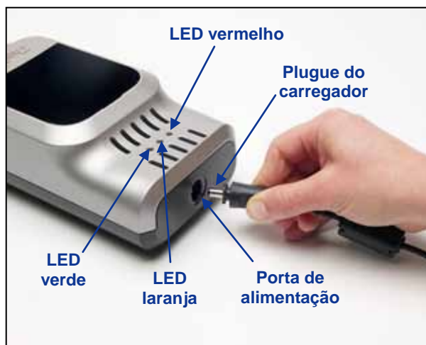
Inserir o plugue do carregador na porta de alimentação
