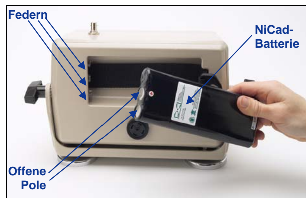
Einlegen der Batterie in das Fernanzeigegerät
